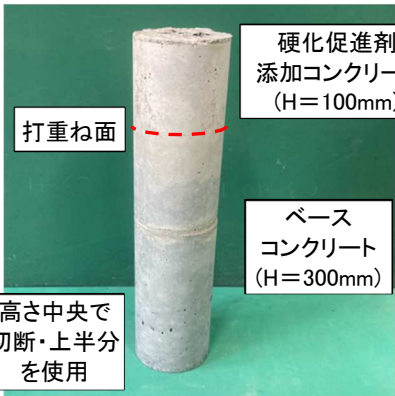
写真-1 打重ね供試体脱型状況
