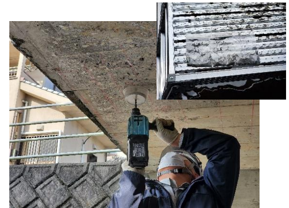
塩化物測定用粉末の採取
