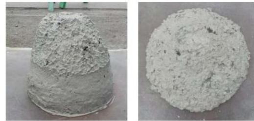
SL=11.5cm タンピング後の状態 写真－4 No. 3 のスランプ試験後の状態
