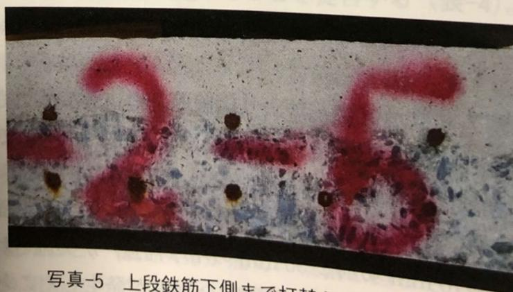
写真-5 上段鉄筋下側まで打替えた床版 (健全)
