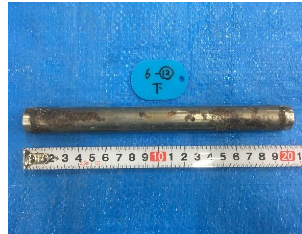
④鉄筋の腐食状況 (暴露8ヶ月後) (塩化物付与10kg/m 3 含有)
