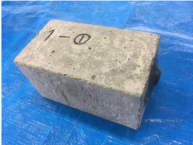
①みがき鉄筋入り供試体
