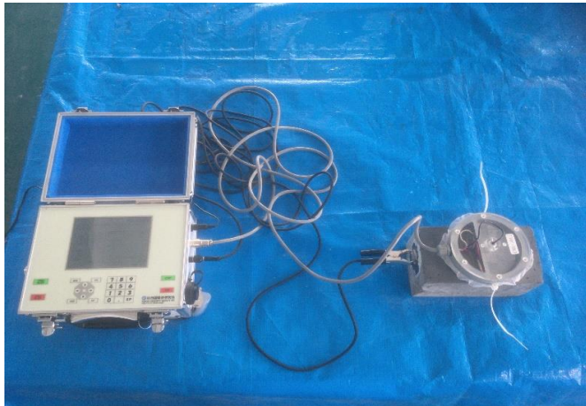
③自然電位測定 (携帯型鉄筋腐食診断器：四国総研SRiCM-V)
