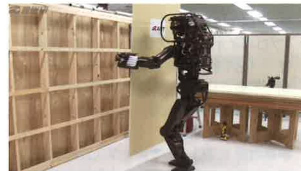
人間のよう石膏ボードを持ち上げ、取り付ける。 (資料) 産業技術総合研究所
