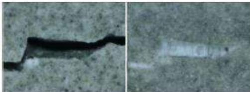
左は幅0.2mmのひび割れ。右は水を供給して7日後にひび割れが閉塞した様子(写真: CORE技術研究所)
