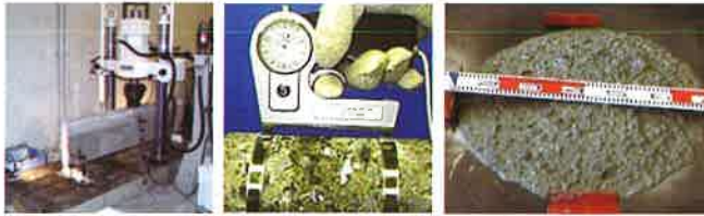
鉄筋コンクリート梁の瘦劣試験
