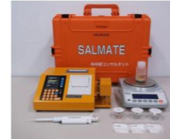
図 6.1 迅速法 レディーミクストコンクリート単位水量測定要領(案) 掲載手法
