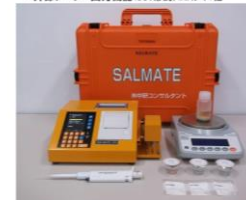
図 6.2 迅速法 レディーミクストコンクリート単位水量測定要領(案) 掲載手法
