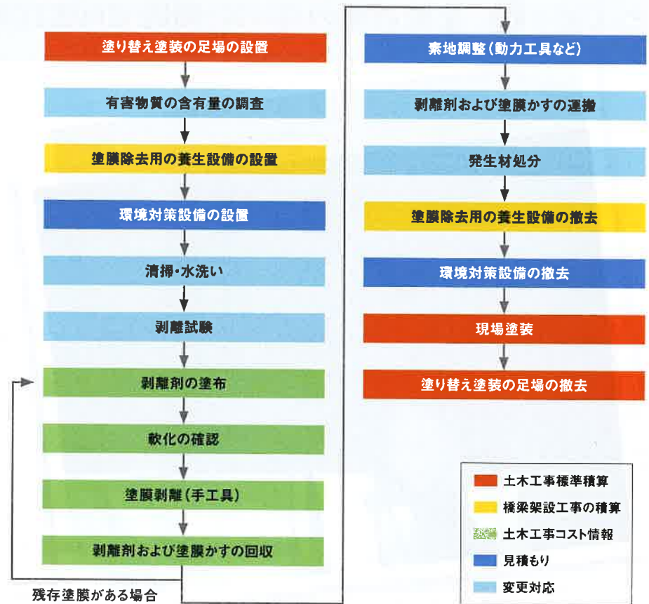
図5 ■ 湿式塗膜剥離工法の適用歩掛かりと適用フロー
